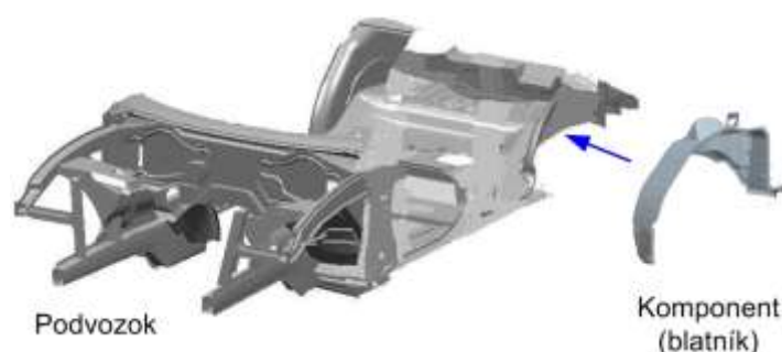
Obr. 1 Model skeletu automobilu v 3D zobrazení
